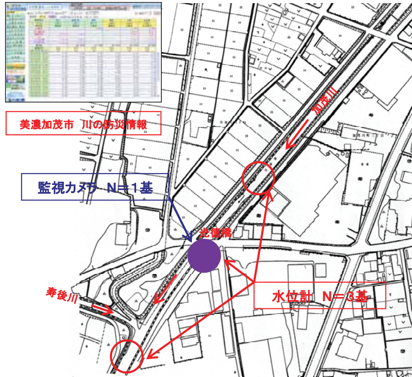
図- 3.6.15 監視カメラ、水位センサーの設置箇所
