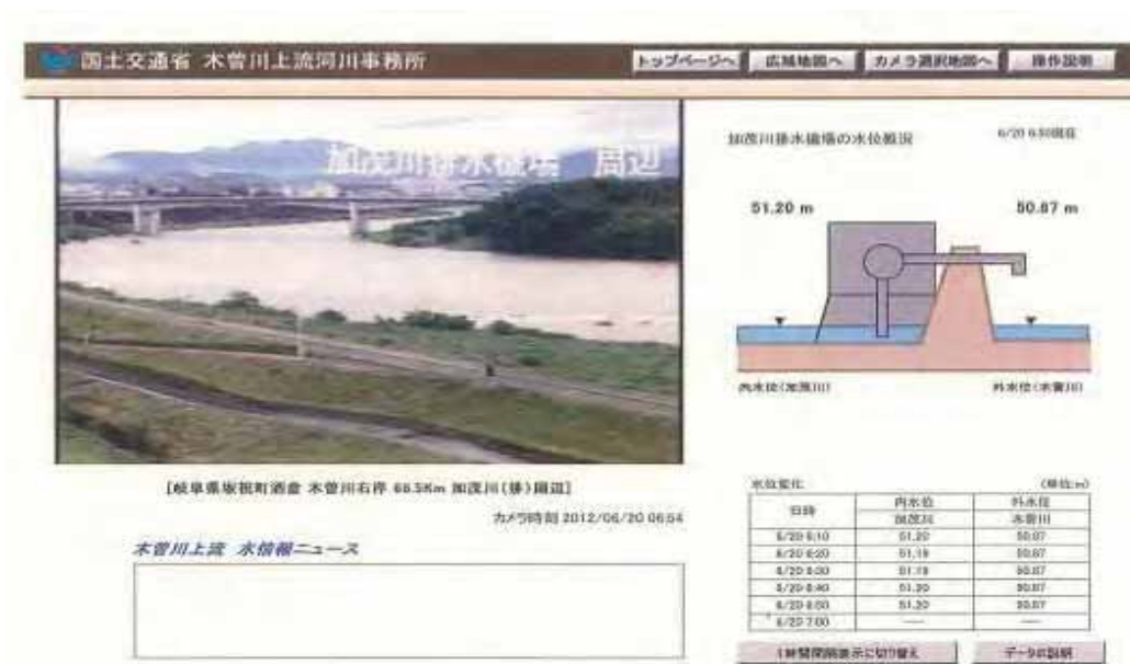
図- 3.6.1 量水標、CCTV設置イメージ
